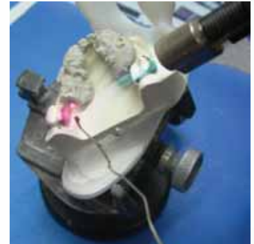
Soldadura con soplete de gas y aire
